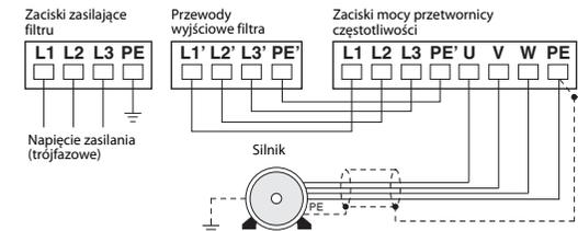
W celu zredukowania emisji zakłóceń, kabel ekranowany silnika musi być uziemiony na obu końcach.
