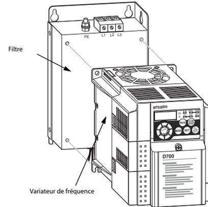
Vissez ensuite l'unité composée d'un filtre et du variateur de fréquence sur l'embase de montage de l'armoire électrique à l'aide de vis adaptées (non fournies). Afin d'obtenir une action du filtre optimale, il est nécessaire que le boîtier du filtre antiparasite et l'embase de montage mise à la terre soient ensembles conducteurs. Cela est normalement réalisé en vissant les filtres sur la plaque de montage.
