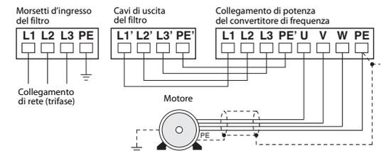
Per ridurre l'emissione di radiodisturbi, il cavo fra l'inverter e il motore deve essere schermato. Lo schermo del cavo motore deve essere collegato su entrambe le estremità con un'ampia superficie di contatto.
