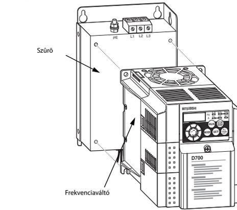
Rögzítse a szűrővel együtt a frekenciaváltót a vezérlőszekrény hátlapjához közönséges csavarok (nem mellélt tartozékok) segítségével. A szűrő megfelelő működéséhez a szűrőnek villamos kötésben kell lennie a vezérlőszekrény megfelelően földelt hátlapjával. Szükség esetén szedje le a festéket a szűrő talpairól.
