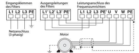
Die Leitung zwischen Frequenzumrichter und Motor ist zwecks Reduzierung der Funkstörstrahlung geschirmt auszuführen. Der Schirm der Motorleitung ist motor- und frequenzumrichterseitig großflächig aufzulegen.
