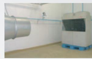
اختبار قوة تحمل الوحدة الخارجية عند الامطار
