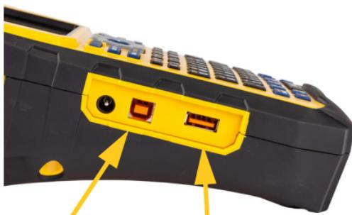
Puerto USB para conexión del cable a un ordenador
