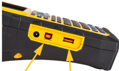
USB-poort voor kabelaansluiting op een computer
