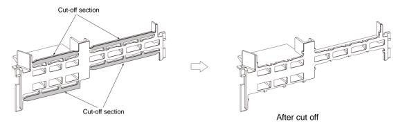
Figure 2.2-8 Wiring Guide (VXT-72A-4)
