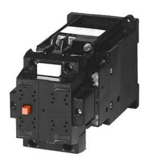
CONTACTOR, SIZE 2, 2-POLE DC-3 AND 5,RATD.OPERAT.CURR.32A AUXILIARY CONTACTS 22 (2NO+2NC) DC OPERATION DC 48V
